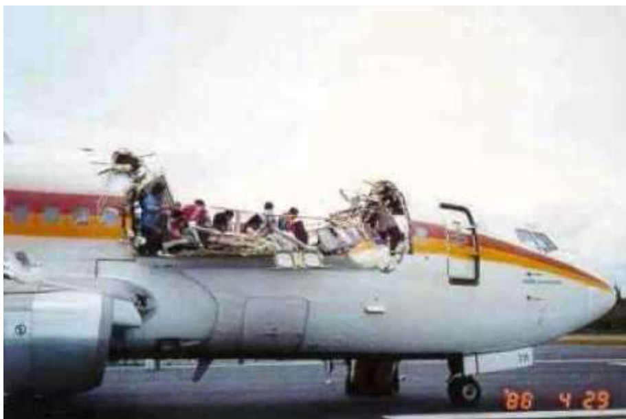
Рис. 1.1. Руйнування фюзеляжу літака Boeing 737-200 внаслідок багатоосередкового пошкодження.
